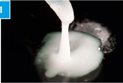
La poudre **DCMhotbond fusio 12** doit être mélangée au liquide **DCMhotbond fusio liquid** jusqu'à obtention d'un mélange crémeux.
