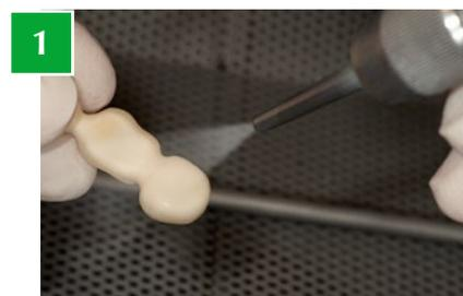
Avant le bonding, tout traitement de surface à l'aide d'instruments diamantés doit se faire sous irrigation pour éviter les fêlures et les pertes de résistance mécanique. Il est recommandé de sabler à l'alumine de 110µm à une pression de 2 bar. Nettoyer à l'air comprimé et s'assurer que la surface à traiter est bien propre (photo 1).
