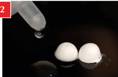
Déposer quelques gouttes du **DCMhotbond zircon liquid** sur la poudre jusqu'à ce qu'elle soit complètement imbibée.
