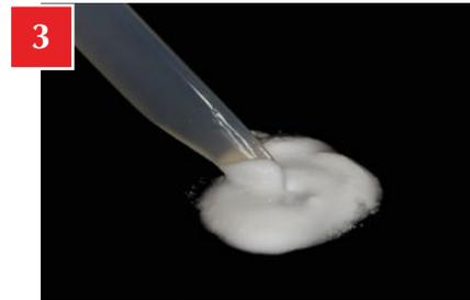
Bien mélanger à l'aide d'une spatule agate de manière à ne laisser ni bulles ni grumeaux (photo 3). La consistance optimale se compare à un état crémeux qui ne doit pas goutter.
