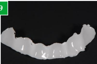
Les armatures de bridges Maryland et les éléments rétentifs doivent être posés sur un support de cuisson rembourré. Le programme de cuisson ci-dessous doit être utilisé. L'état de surface après application de DCMhotbond zirconnect doit être légèrement brillant (photo 9).
