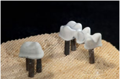
钛制冠部，锻烧后烘烤物支架上的钛制桥部
