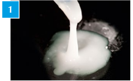
يُخلط مسحوق دي سي إم هوت بوند فوزيو ١٢ مع دي سي إم هوت بوند فوزيو السائل بكمية معيارية لتكوين قوام دسم
