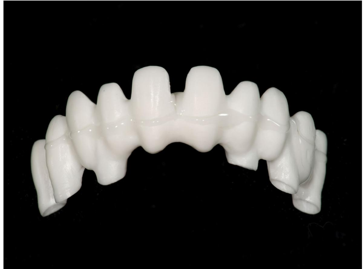
Fertigungs-indizierte Spannungen oder Verzüge stehen den zahnmedizinisch gewünschten präzisen Gerüstpassungen entgegen und verhindern deren Inkorporation. Durch ein Trennen und anschließendes Fügen dieser Gerüste mit **DCMhotbond zircon** lässt sich eine präzise Passung diese Gerüste erreichen.
