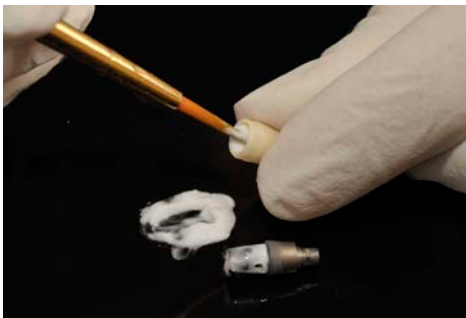
DCMhotbond fusio Pulver und DCMhotbond fusio liquid werden in dosierter Menge zu einer sahnigen Konsistenz angemischt
