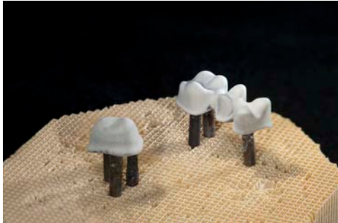
Titankrone, Titanbrücke auf Brennträger nach dem Brand
