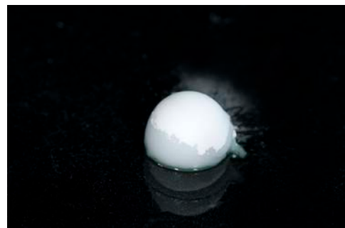
Liquid aufgesumpft durch das Pulver
